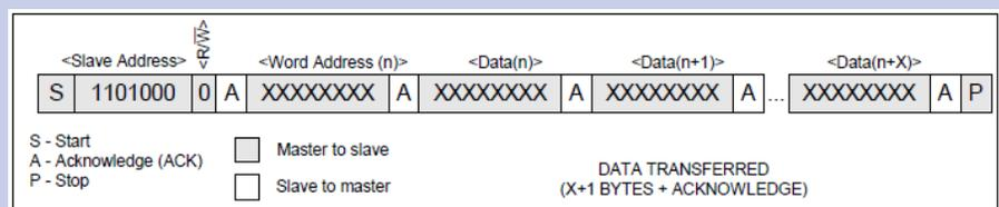
Fig.4. Data write to slave sequence (Source Maxim DS1337 datasheet)
