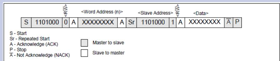
Fig.5. Data read sequence (Source Maxim DS1337 datasheet)
