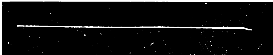
cl. 2. — Traiectoria completă a unei particule \alpha emise de un nucleu de radon desintegrat chiar în gazul camerei. Se observă către sfârșitul parcursului (dreapta) o deviație datorită unei ciocniri cu un nucleu (cl. Rutherford, Chadwick, Ellis, Radiations from Radioactive substances ).
