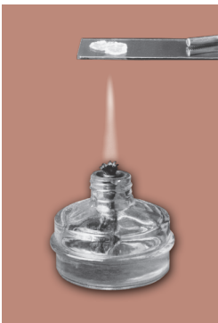
Рис. 3.10. Выпаривание воды из раствора
