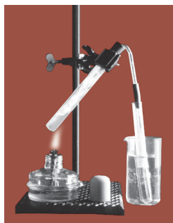
Рис. 3.6. Дистилляция (перегонка) воды в простейшем приборе
