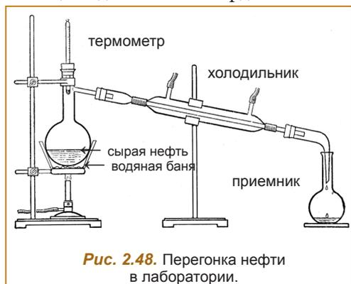
**Нефть.** При перегонке нефти в лаборатории (рис. 2.48) можно убедиться, что она разделяется на фракции: вначале в приемник переходит жидкость с низкой температурой кипения, затем при более высоких температурах – углеводороды с большей молекулярной массой. Нефть вначале перегоняют при обычном давлении (первичная перегонка), затем в вакууме (вторичная перегонка).
