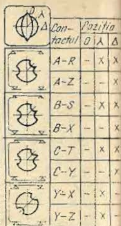
Fig. 4.9. Schema unui comutator stea-triunghi.
