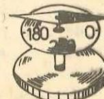
Fig. 10.14. Ac magnetic cu cadran gradat.
