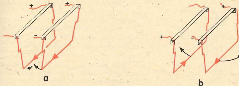
Fig. 6.35. Curenții electrici de același sens se atrag (a); curenții electrici de sens contrar se resping (b).
