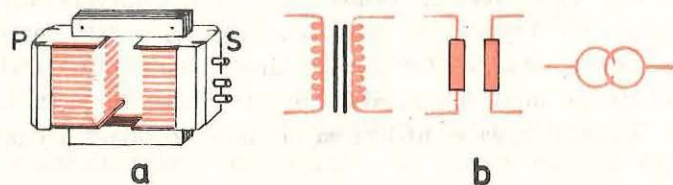
Fig. 7.29. Transformatorul electric: a) dispozitivul asamblat; b) semne convenționale.
