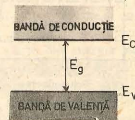
Fig. 3.23. Reprezentarea simplă a benzilor energetice într-un semiconductor.
