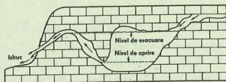
Fig. 92. Schema de funcționare a unui izbuc.
