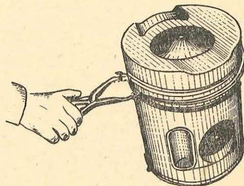
Fig. 14.6. Montarea segmentelor metalici în canalele unui piston.
