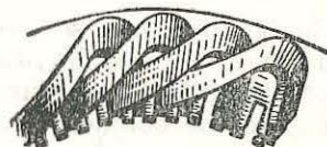
Fig. 6.48. Înfășurare într-un singur strat, din bobine egale, cu capete de bobină în lanț.
