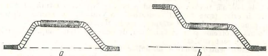
Fig. 6.41. Semibobină: a - pentru înfășurare buclată; b - pentru înfășurare ondulată.
