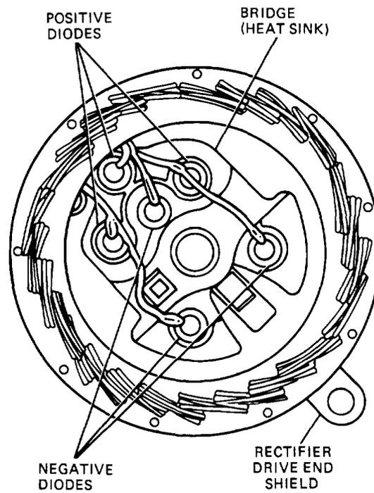
Figure 13-22. Diode Arrangement Rectifier Bridge.
