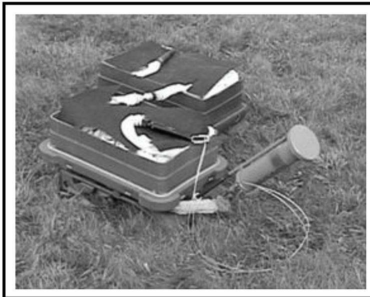
**Figure 14-22. MK7 Antipersonnel Obstacle-Breaching System (APOBS).**
