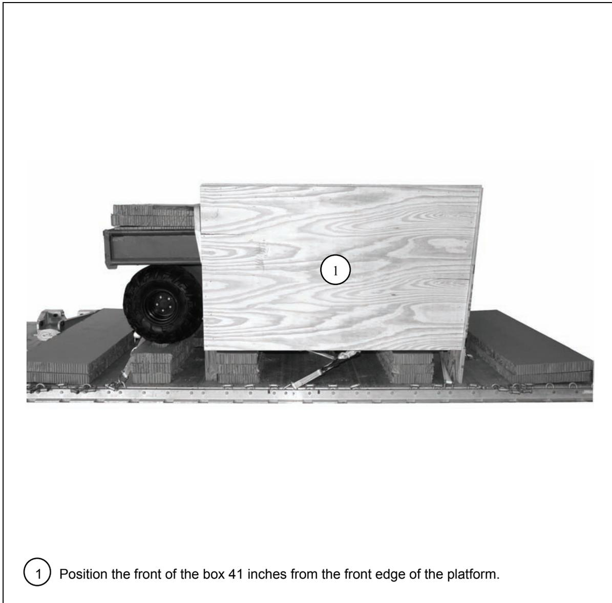
**Figure 10-11. M-Gator Box Positioned**
