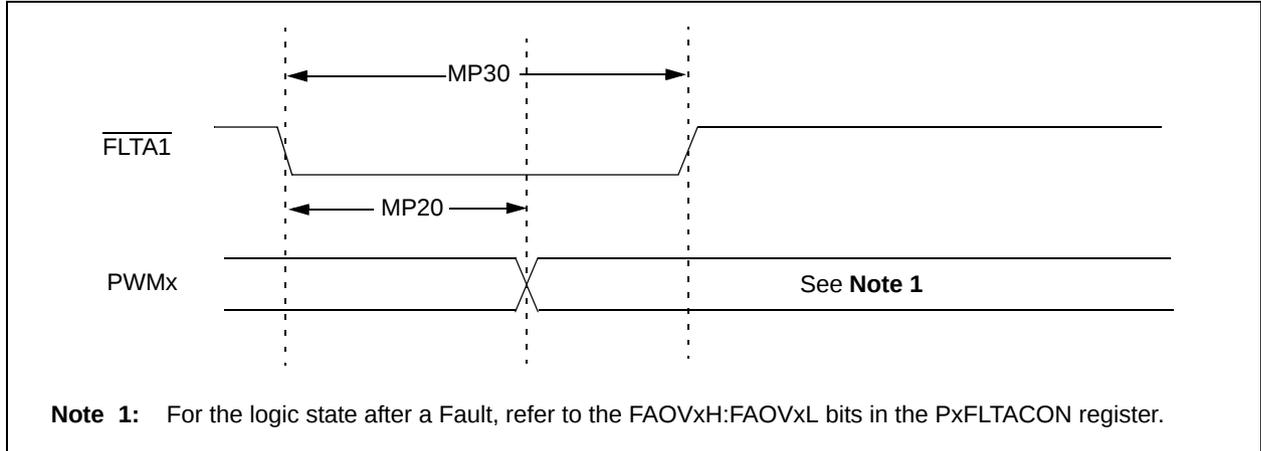
**FIGURE 26-10: MOTOR CONTROL PWM MODULE TIMING CHARACTERISTICS**
