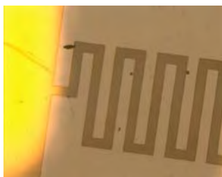
Imagine a structurii de detector pe YBCO. Variația rezistenței la iluminare
