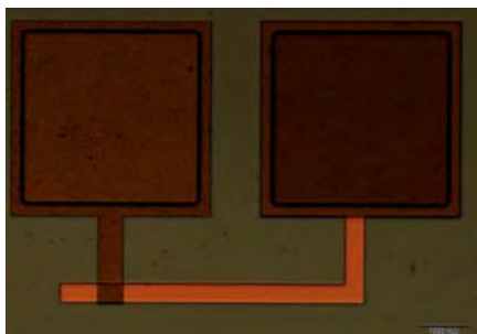
Imaginea optica a cantileverului din polisiliciu dopat pentru masuratori vibrationale
