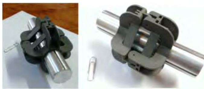
b.) Senzorul de torsiune montat pe axul metalic.
